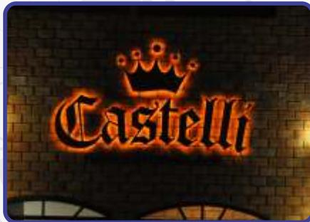
Letra caixa em chapa galvanizada com pintura automotiva e iluminação em LED por trás.
