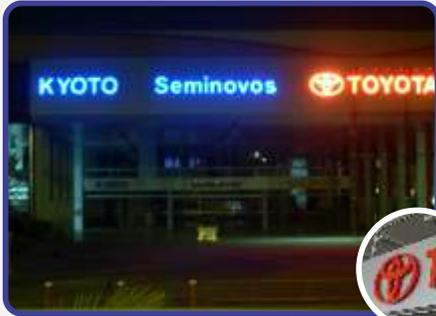
Modulação em ACM com letra caixa com iluminação em NEON.
